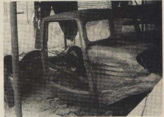
Seule la cabine du conducteur est en tôle - mais le soubassement est en planches de bois plates !
