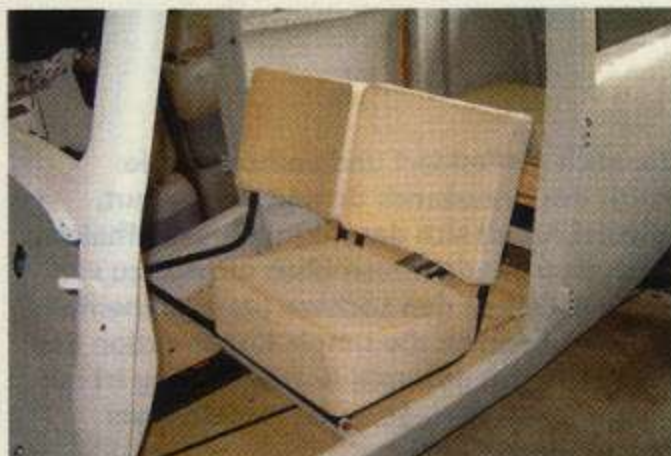
Na bitte, es wird doch: An seinem raren Kombi-Dreiradwagen brachte sich der Schrauber den Umgang mit Blech und Schweißgerät bei. Die simple Karosseriestruktur erleichterte den Lernprozess, der dennoch Monate dauerte. Einzig der Boden der Karosserie besteht aus Holz
