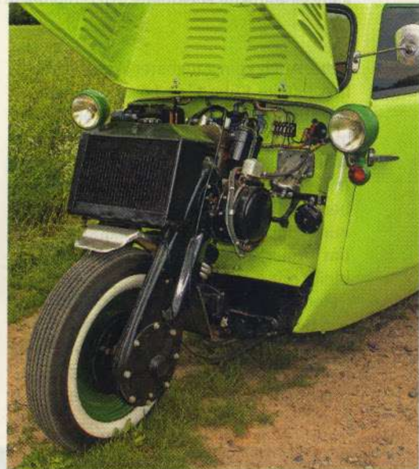
Kraftwerk: Den 12,5 PS starken, wassergekühlten Motor lieferte die Firma ILO zu
