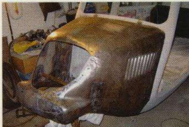
Et voilà, ce sera : Le mécanicien a appris tout seul à utiliser de la tôle et une machine à souder sur son rare break à trois roues. La structure simple du corps a facilité le processus d'apprentissage, qui a néanmoins pris des mois. Seul le bas du corps est en bois
