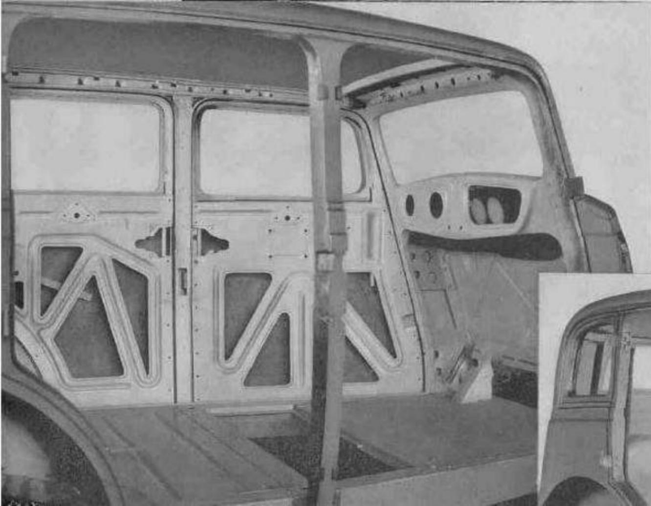
La carrosserie tout acier du nouveau Willys 77 est une grande avancée par rapport aux autres. Les portes, les piliers, les seuils, les traverses et les panneaux de plancher sont de construction entièrement en acier... Le résultat est une plus grande résistance et une plus grande rigidité. Les carrosseries fermées sont insonorisées et à l'épreuve des intempéries.
